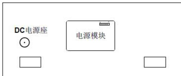
图：太阳能路灯智能控制器后面板图
