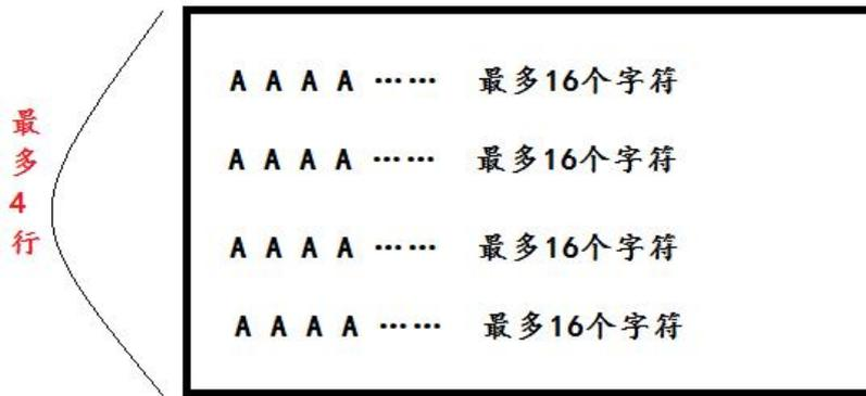
图：太阳能路灯智能控制器液晶屏显示格式
